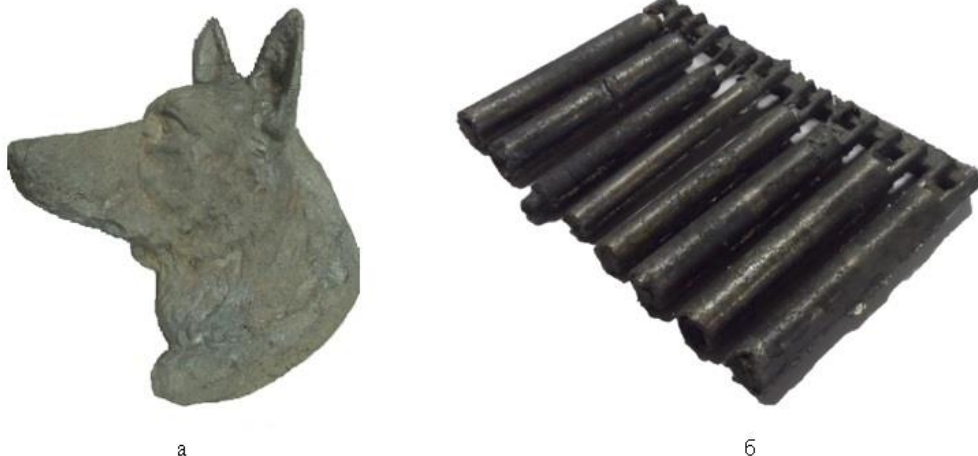
Рис. 7. Виливки, виготовлені із використанням форм і стрижнів із ЗК на основі ТПФН.
